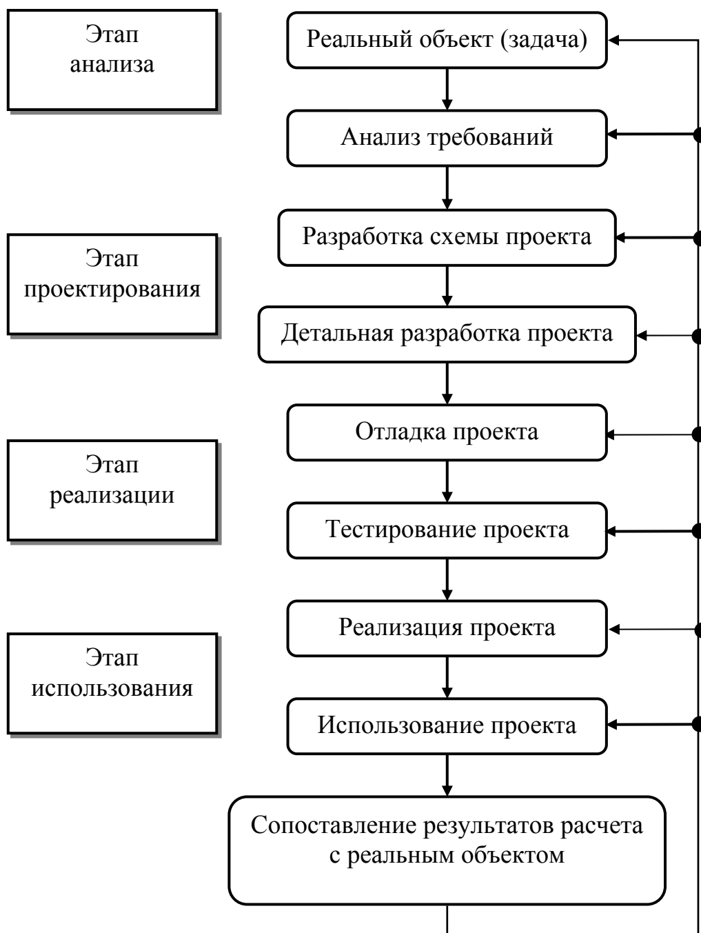
Рисунок 1 - Схема процедурного процесса создания проекта
