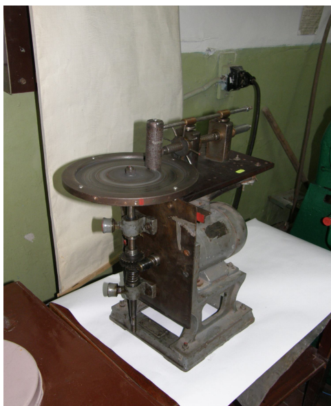
Рисунок 3 – Устройство для определения износостойкости
