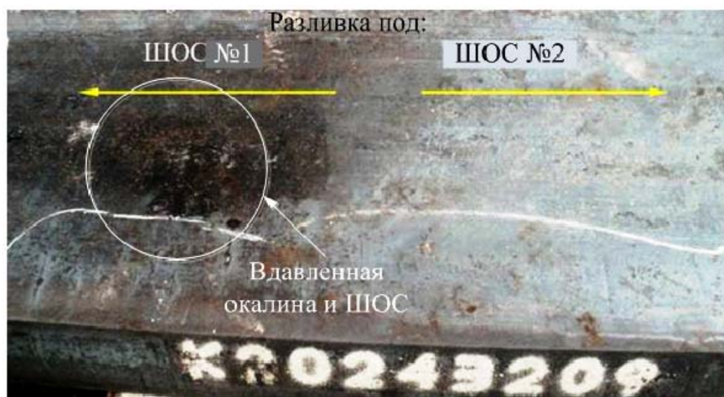
Рисунок 4 – Фрагмент поверхности сляба марки 09Г2С при разливке которого была произведена замена ШОС №1 на ШОС №2
