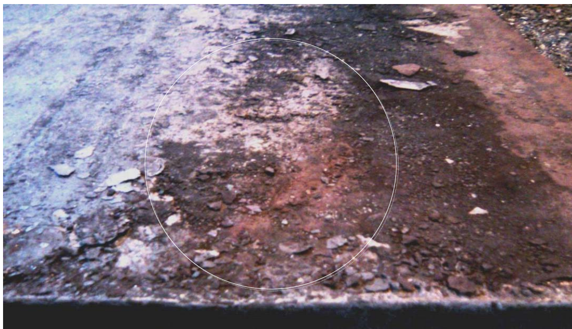
Рисунок 1 – Фрагмент поверхности сляба марки С091ТМ с дефектом поверхности – запрессованными участками скопления окалины и шлака
